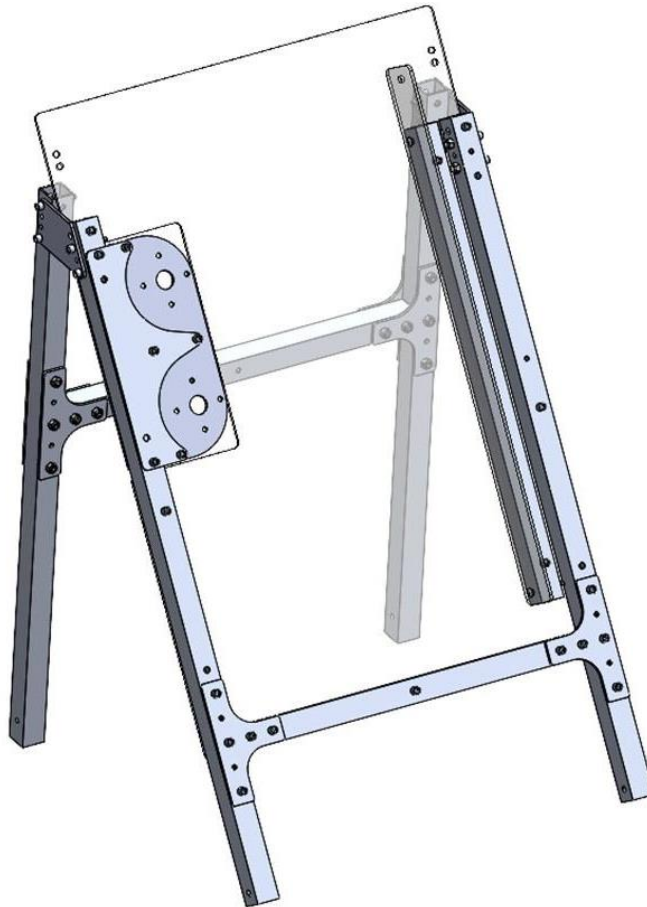
Figura 32: Fixação do Trilho de Lançamento
