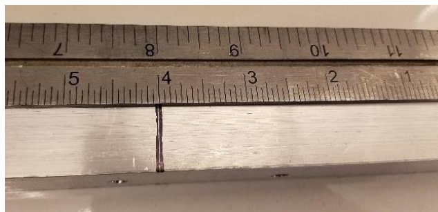
Figura 12: Marcação de 4 pol. na barra
