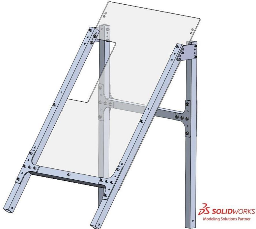
Figura 21: Fixação das estruturas juntas
