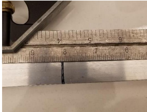
Figura 5: Marcação de 8 pol. no tubo vertical
