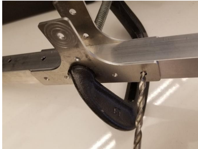
Figura 7: Fixação dos suportes em T na barra
