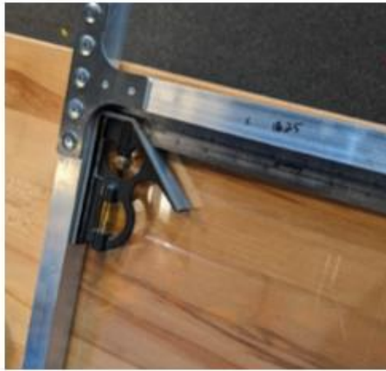
Figura 15: Fixação do Tubo Horizontal na Estrutura Traseira
