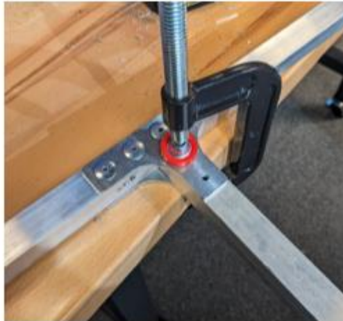
Figura 9: Fixação do tubo horizontal
