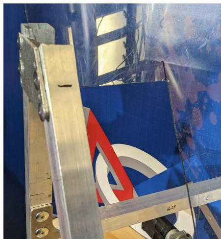
Figura 28: Marcação do Tubo Diagonal
